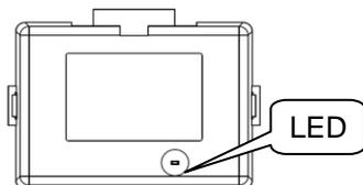
① 車両キーでイグニッション(以下 IG と表記)を ON にします。(登録作業が始まり LED が速い点滅をします。)
