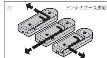
3 両面テープのセパレータを取り、ケース裏側の枠に合わせて貼り付ける
