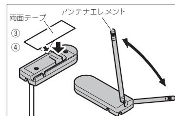
4 両面テープのセパレータを取り、車両側の取り付け場所へ貼り付けして、アンテナエレメントの角度を調整する（※1）
