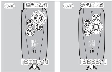
※1…「電子キーの認証失敗」のアンサーバックが出たときは、電子キーの認証ができないため、エンジンの始動ができません。もう一度「START」操作を行ってください。
