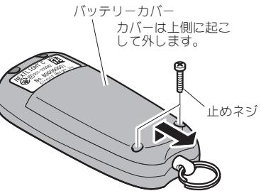
2 古い電池を取り外し、+側が上になるように新しい電池（CR2032×2個）と交換する。
