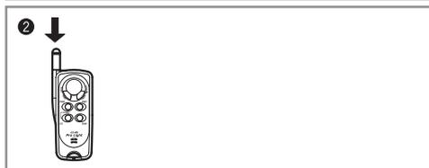
※3...車との距離が離れていないときは、アンテナを伸ばさずに操作しても、電波が届く場合があります。このように近距離で使用する場合は、インフォメーション機能(16ページ)でアンテナを収納したままで電波到達エリア内の確認ができれば、アンテナを伸ばさずに使用してください。
