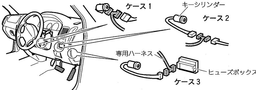
ケース1 コラムカバーを外して、キーシリンダーから直接出ているコネクタに接続。
