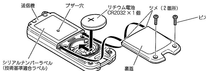
※1 電池は消耗していくと、特に低温時に性能が低下してきます。このため極低温の環境で使用した場合、送信モニターランプが5回点滅せずに作動しなくなることがあります。
