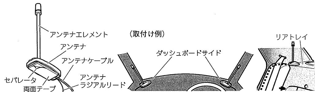
※1 アンテナエレメントは、できるだけ垂直に調整した方が電波到達距離は長くなります。
