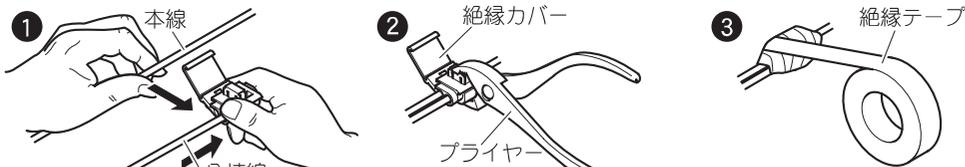
分岐したい本線をエレクトロタップにはめ込み、分岐線をエレクトロタップの横の穴に差し込む。
