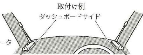
※1 アンテナケーブルは、引き出す方向を変えることができます（左右に引き出すための凹部があります）。
