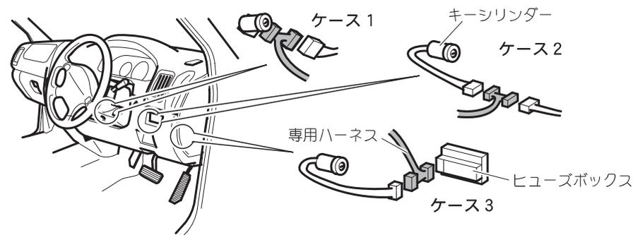
ケース1 コラムカバーを外して、キーシリンダーから直接出ているコネクタに接続。
