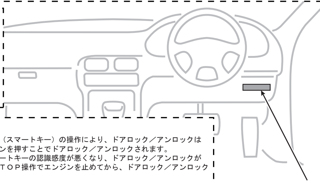
ロアカバー内右上側 キーフリーECUの 40P白色カプラ
