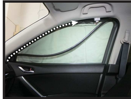
②ウェザーストリップを外し送信ユニットへのハーネスを点線のように沿わせる
