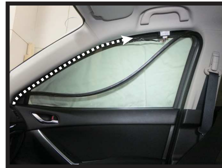
②ウェザーストリップを外し送信ユニットへのハーネスを点線のように沿わせる（できるだけセンターピラー側へ取り付け）
