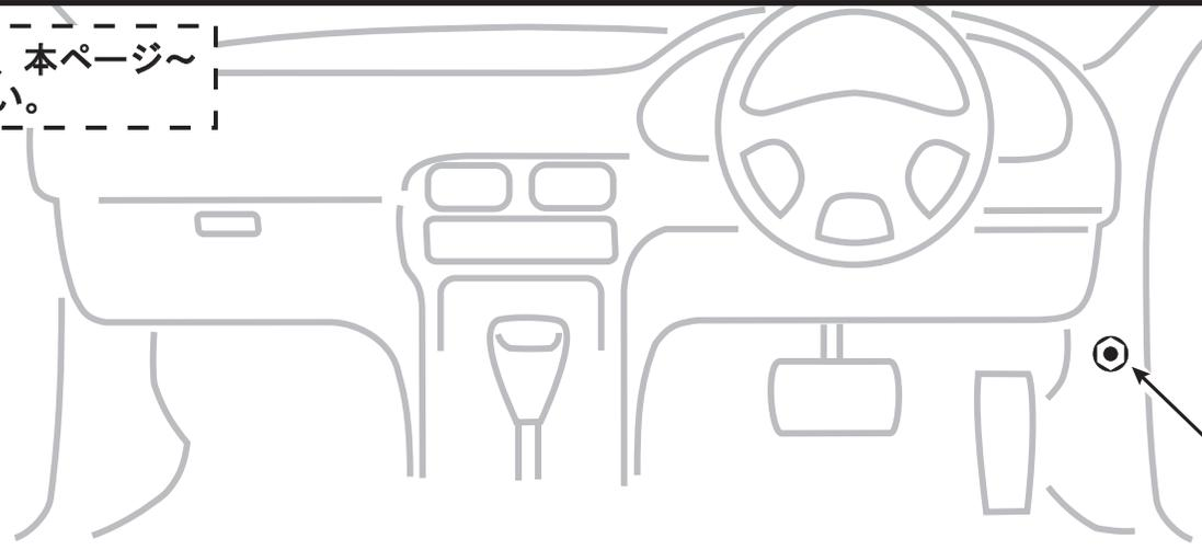
❗ 専用ハーネスのアース（黒）取り付け位置：右サイドカバー内上側の金属ステー固定ボルトに共締めする。
