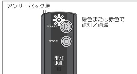
●リモコンがアンサーバックをせずにLED表示が青色で点灯／点滅する場合は電波環境が悪く通信が正常にできていません。もう一度操作を行ってください。（※2）
